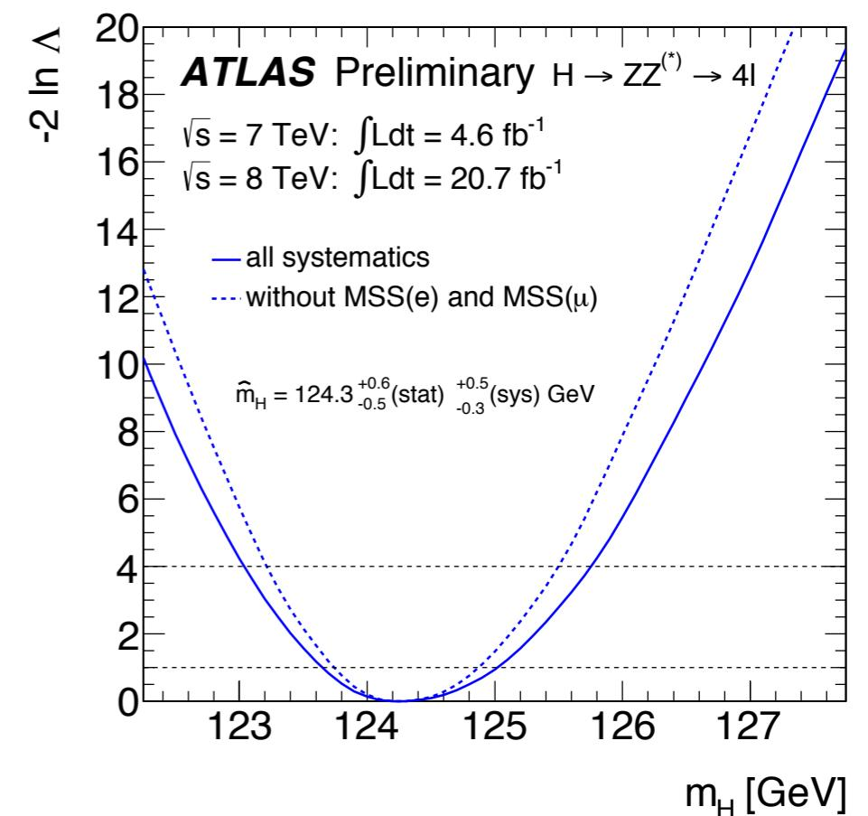
$$m_H = 124.3^{+0.6}_{-0.5} (\text{stat})^{+0.5}_{-0.3} (\text{syst}) \text{ GeV}$$
