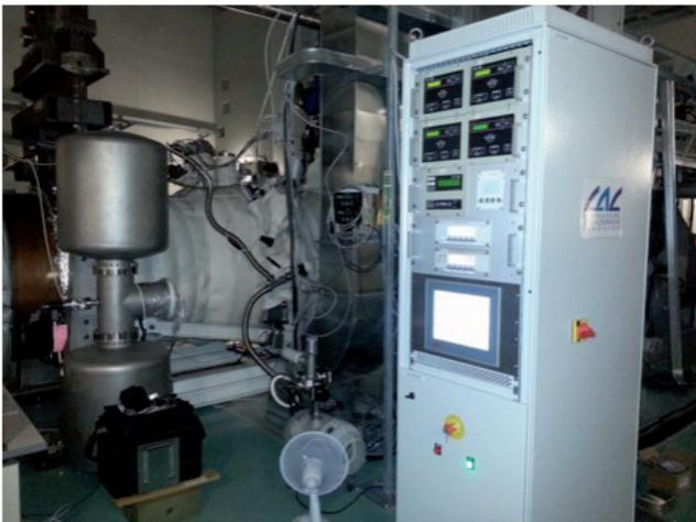
*Figure 1 : Vue de la cryotrappe à l'extrémité Ouest de Virgo, empaquetée dans son isolant, et de la baie produite par le LAL permettant son contrôle.*
