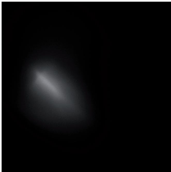
*Fig. 1 : Observation sur un écran scintillant des électrons produits par un tir du laser de Laserix sur la photocathode de PHIL.*
