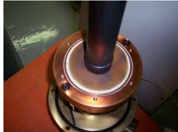
Maintenance adaptative sur coupleur RF
