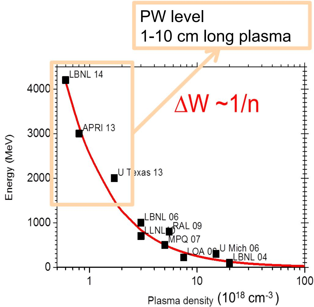
Diminuer la densité conduit à une plus forte énergie des électrons, pour une puissance laser plus élevée et un plasma plus long
