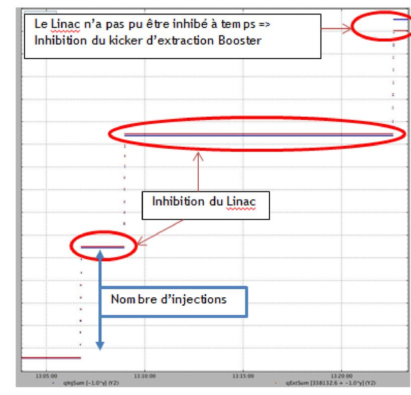
Exemple du seuil de courant inhibant l'injection dans l'anneau de stockage: pour empêcher tout dépassement du courant maximum légalement possible, l'inhibition doit se faire en moins de 190 ms. Le système de détection par automate associé à une inhibition en parallèle du Linac et du système d'extraction booster le permet.
