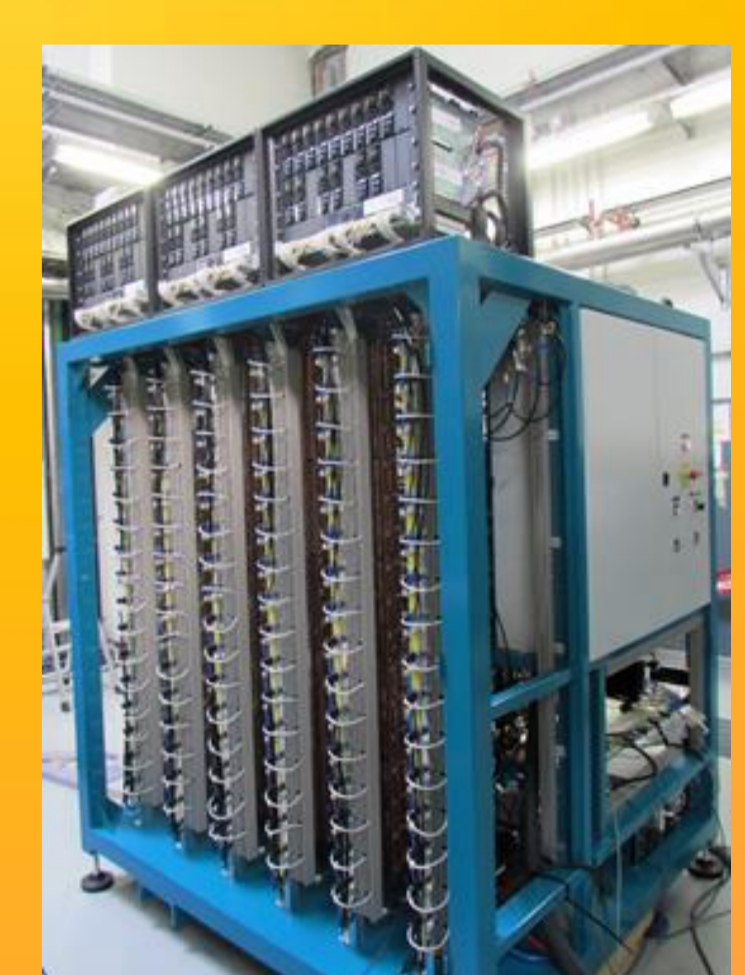
50 kW à 500 MHz pour Thomx (6 dissipateurs de 16 modules)
