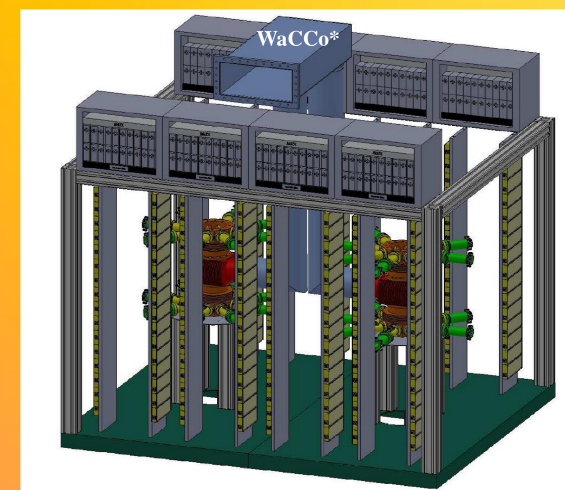
150 kW à 500 MHz, initialement conçu pour SESAME avec 16 dissipateurs de 16 modules
