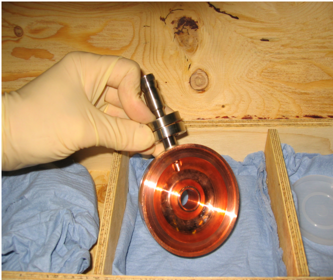
Demi-cavité de prégroupement avant brasage
