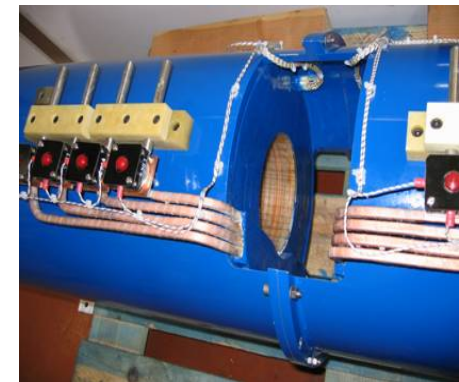
Solénoïde de focalisation 2000Gauss
