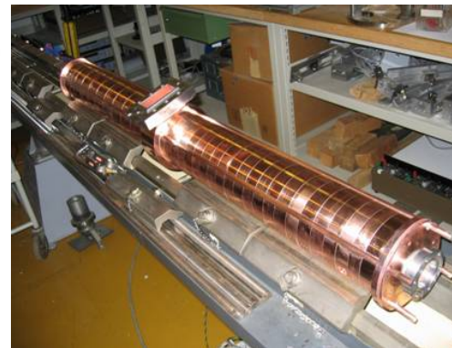
Alignement des cellules en cuivre 1m de long, 15MeV
