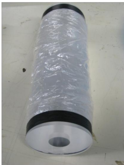
Photo du scintillateur utilisé pour la mesure du temps de vie du muon (protégé par un plastique). Crédit : Sciences à l'Ecole.
