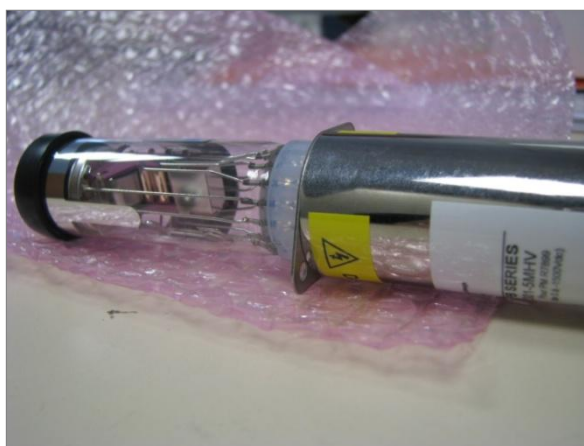
Photomultiplicateurs utilisés dans le cosmodétecteur. Crédit : Sciences à l'Ecole
