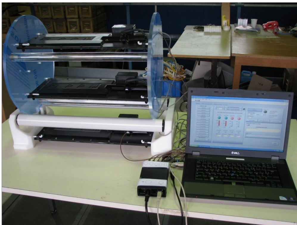
Cosmodétecteur en fonctionnement relié à l'ordinateur. Crédit : Sciences à l'Ecole.
