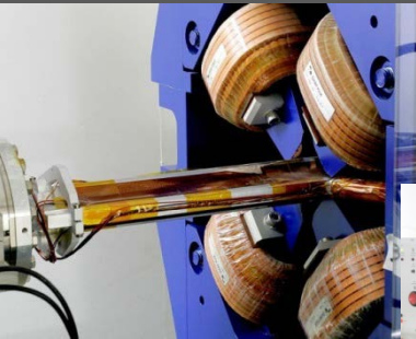
Focalisation du faisceau d'électrons quadrupôle sextupôle
