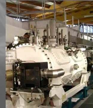
Anneau de stockage Cavité accélératrice (352 MHz)
