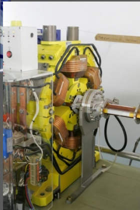
Focalisation du faisceau d'électrons quadrupôle sextupôle
