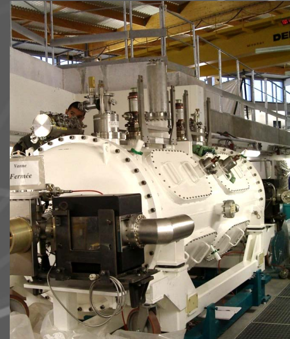
Cryomodule Cuve à hélium liquide (-269°C)
