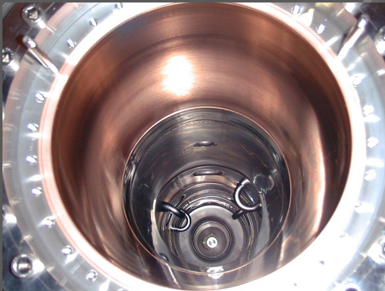
Cavité radio fréquence supra en cuivre avec dépôt de Niobium (352 MHz)
