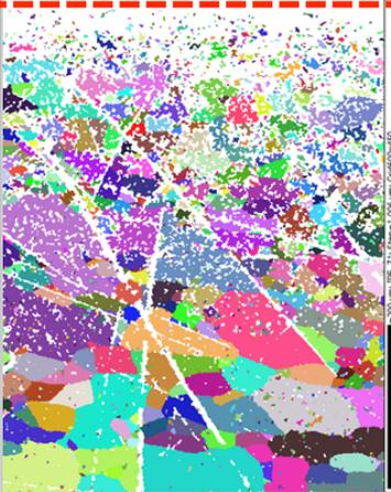
En surface Les grains sont petits, distordus (sur une épaisseur > 250 μm).
