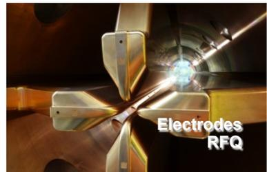
Tension nominale de la cavité RFQ pour les protons 50 kV
