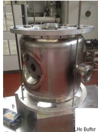
Prototype de cavité spoke (2016)
