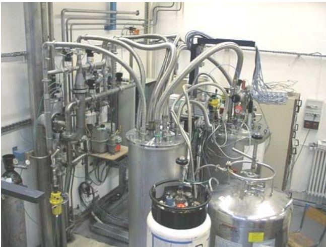
Banc de calibration des capteurs de température cryogénique
