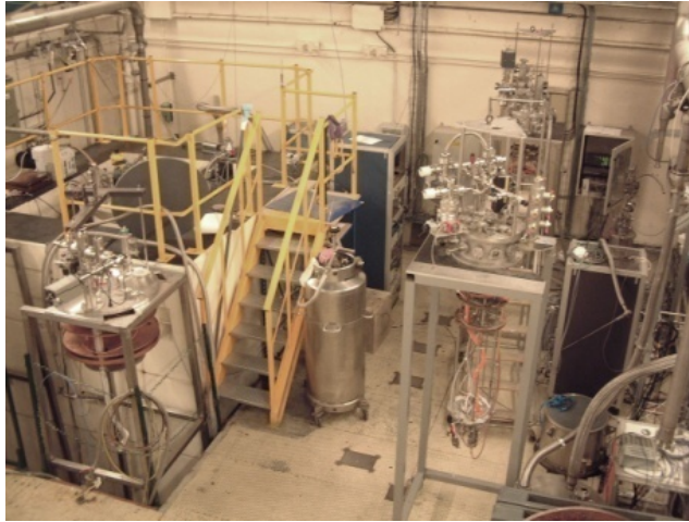
Banc de calibration des capteurs de température cryogénique
