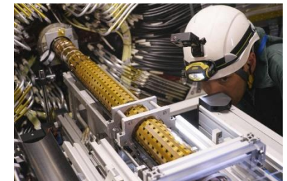
détecteur de pixel (2013) dans ATLAS
