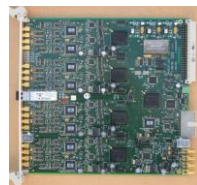
Carte Front-end du Calorimètre
