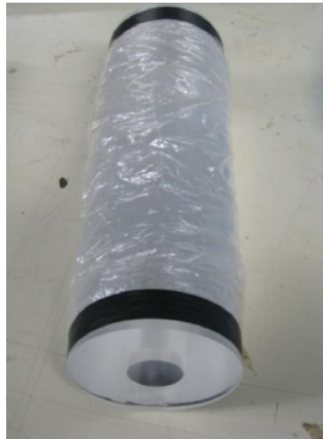
Figure 1.2 – Photo du scintillateur utilisé pour la mesure du temps de vie du muon (protégé par un plastique). Crédit : Sciences à l'École.
