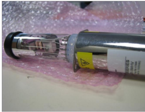
Figure 1.3 – Photomultiplicateurs utilisés dans le cosmodétecteur. Crédit : Sciences à l'École.
