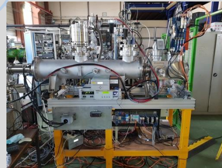
ARIBE : Qualification d'un prototype de module de transport de faisceau à faible perte en réalisant des mesures d'émittance différentielles. Observation de la signature sur les couches périphériques du faisceau lors du passage dans une structure de focalisation quadripolaire (septembre 2021)
