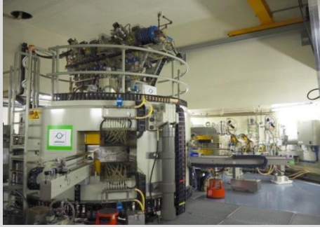
ARRONAX : Installation de l'EmitM dans la ligne d'injection verticale du cyclotron C70 en casemate. Observation de structures de faisceau à densité d'ions non homogènes (avril 2021)
