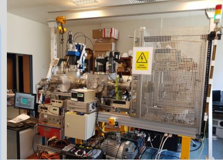
IPHC : Montage de l'EmitM sur un banc pour caractérisation d'une source de type canon à ions césium (HeatWave Labs, Inc). Observation du faisceau focalisé et des aberrations optiques (juin 2021)
