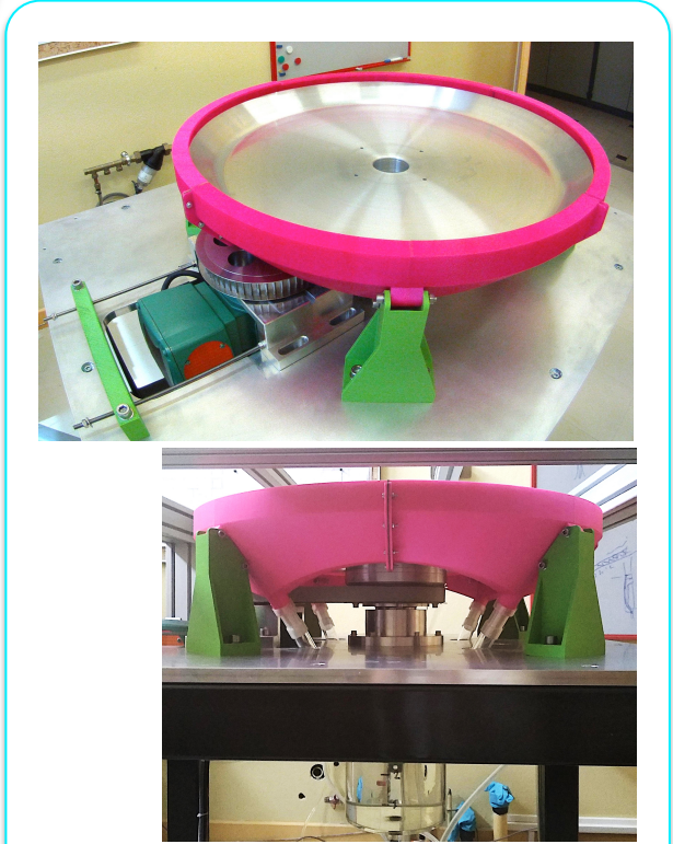
Travail sur maquette en eau pour définir les caractéristiques du rotor et optimiser le design de l'ensemble d'un point de vue hydraulique
