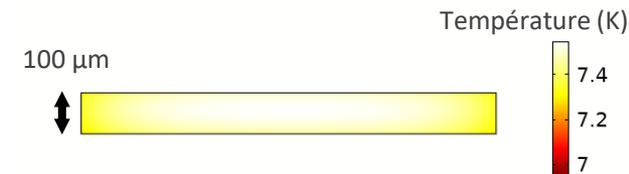
*Sublimation d'un ruban d'hydrogène (durée 0,5 s)*
