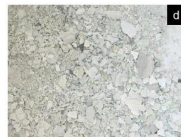
Figure III. 19: Étapes de la fabrication du blanc de plomb commercial issu d'un procédé d'empilement (a) : rouleaux de plomb métallique, (b) : strate de jarres contenant les rouleaux et prêtes à être recouvertes de fumier, (c) : rouleaux corrodés lors de l'ouverture des jarres après 4 mois de corrosion, (d) : pigment obtenu (on constate que le produit s'est détaché sous forme d'écailles). © Natural Pigments
