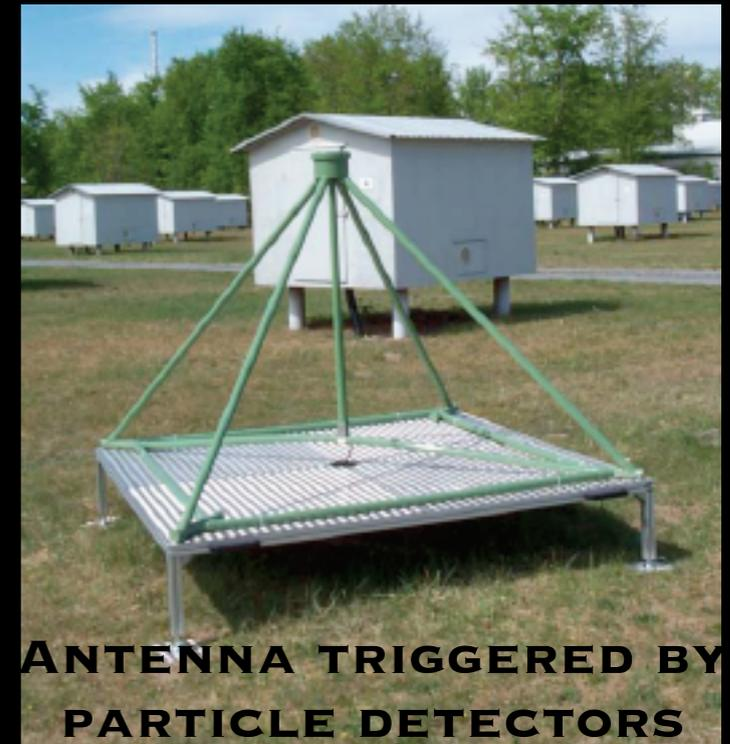
**ANTENNA TRIGGERED BY PARTICLE DETECTORS**
