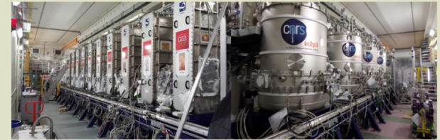
Cryomodules contenant les cavités accélératrices supraconductrices de basse et haute énergie de l'accélérateur linéaire SPIRAL2 au GANIL (crédits : R. Ferdinand)
