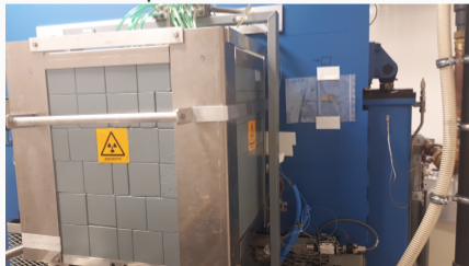
Détecteurs passifs sur la culasse de CYRCé
